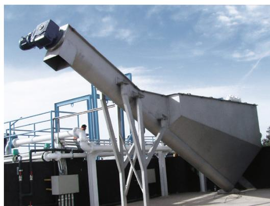
Installation zur Entwässerung von Sandfanggut mit GS 130
